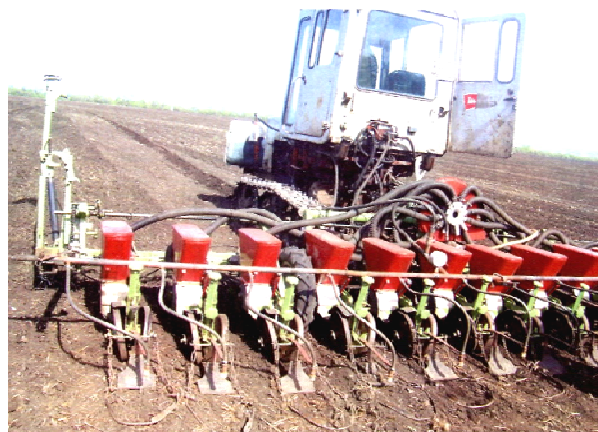
Рисунок 1 Посевной агрегат с навесным оборудованием для полосного внесения эмульсии почвенного гербицида
